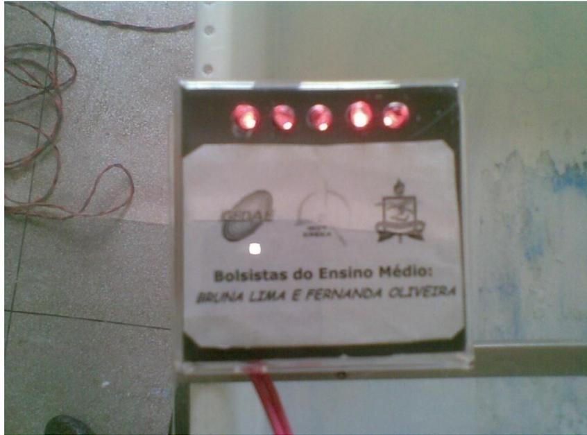
Com isso, a energia elétrica gerada alimentará o conjunto de led's que estão conectados nos terminais das bobinas.
