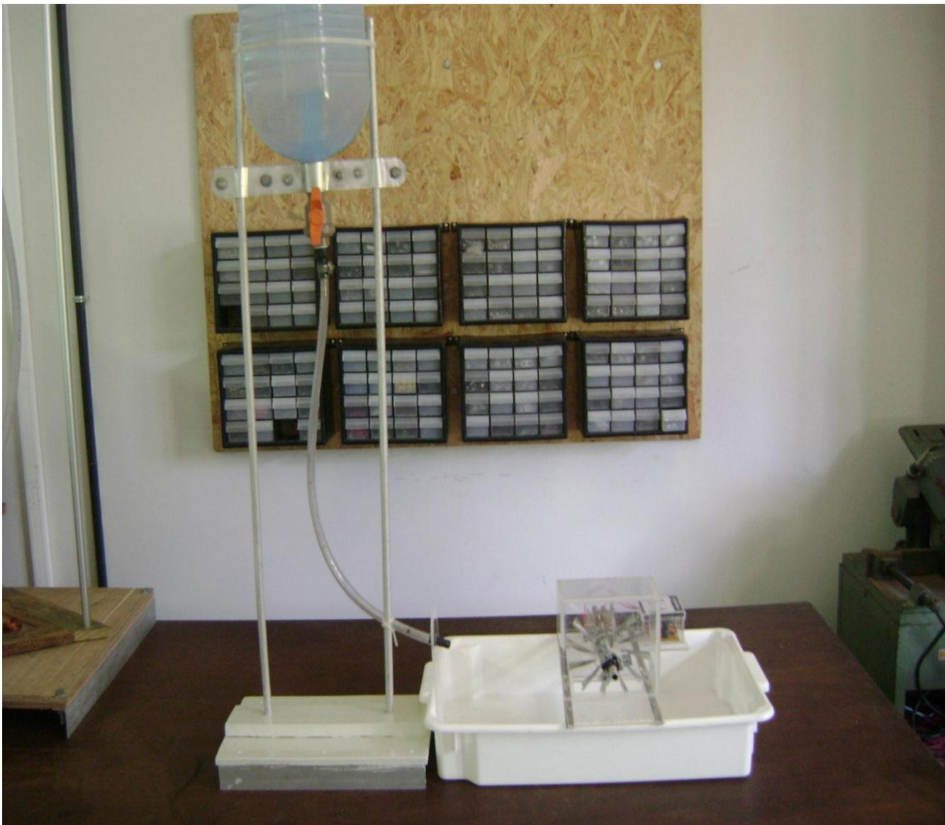
A água armazenada no reservatório é dotada de energia potencial gravitacional. Ao abrir a válvula a água flui pela mangueira (duto), sendo a energia potencial convertida em energia cinética.
